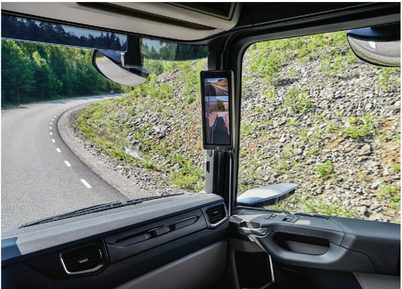
Le rétroviseur numérique (mirror cam) équipant les camions : une caméra et un écran remplacent les rétroviseurs.
